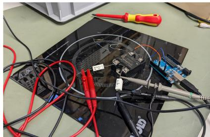
Arduino und im Nulldurchgang schaltendes Halbleiterrelais
