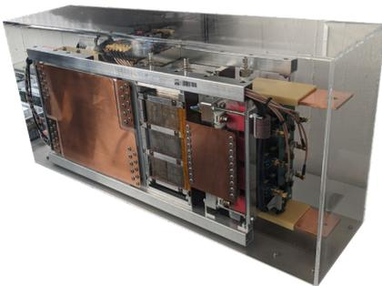
Das 160-kW-System mit einer Schaltfrequenz von 20 kHz
