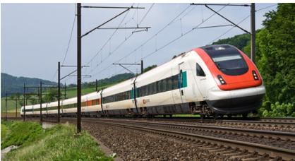
Der InterCity*Neigezug* ist ein von Bombardier/Alstom gebauter, einstöckiger Schnellzug. Er wird primär auf der Strecke Genf-Biel/Bienne-Zürich-Rorschach eingesetzt, da man dort viele Kurven hat und deshalb im Rahmen des
