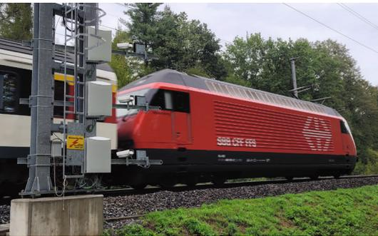
Bereits heute kontrollieren 250 Messsysteme durchfahrende Züge auf dem Streckennetz der Schweiz: Geprüft wird, ob Bremsen oder Achsen heisslaufen, ein Rad unrund läuft, die Ladung eines Wagons verrutscht ist oder Abdeckblenden und Antennen von Lastwagen das Lichtprofil verletzen. Wird eine Gefahr erkannt, alarmiert die Zugkontrollleinrichtung (ZKE) die Leitstelle und der Zug wird sofort gestoppt, verlangsamt oder am nächsten Bahnhof auf ein Interventionsgleis geleitet.
