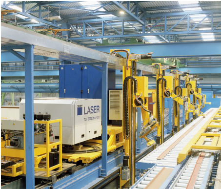
Laserschweissanlage von Schuler Held Lasertechnik in der Mayer-Werft (Foto: K. Wegener)
